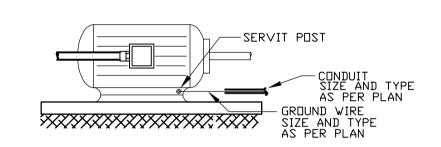
TYPICAL MOTOR GROUNDING DETAIL
