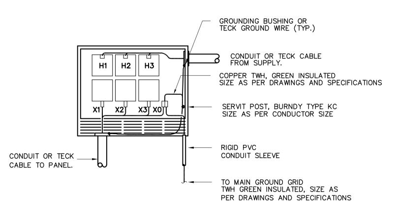
TYPICAL DISTRIBUTION TRANSFORMER GROUNDING DETAIL
