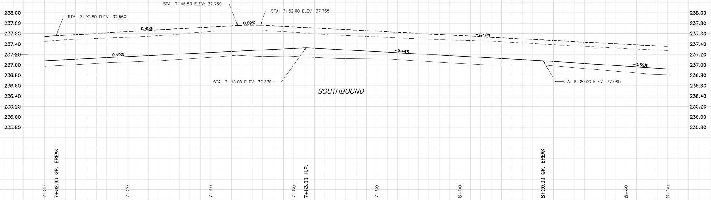
ALL CHAINAGES ARE MEASURED ALONG THE EAST GUTTER LINE OF OAK POINT HIGHWAY
